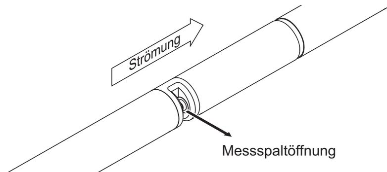
Bild 3-1 Einbau waagerecht
