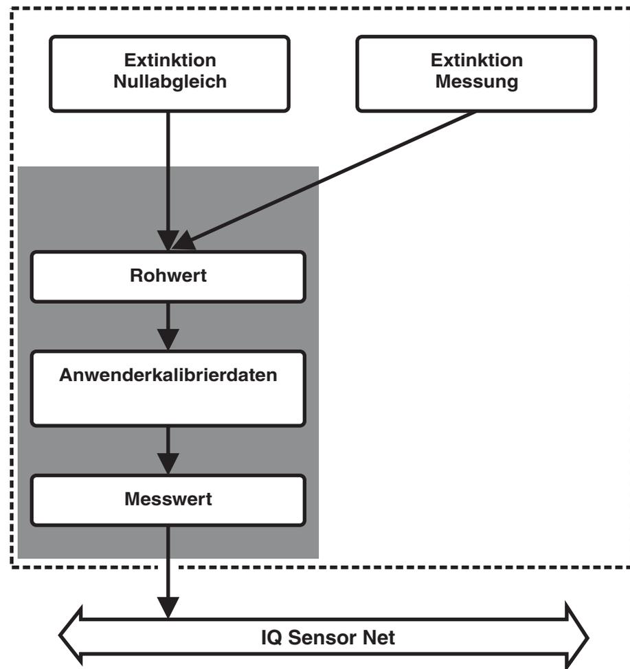
Bild 4-1 Messwertermittlung
